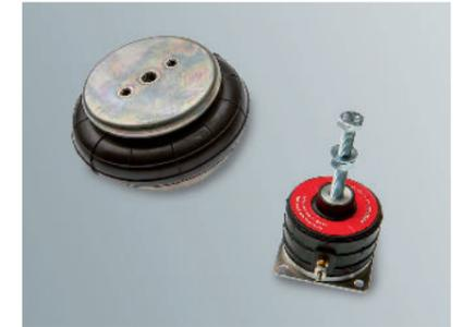
Dans la catégorie des éléments ressorts, les ressorts pneumatiques trouvent leur utilité lorsque des contrôles réguliers sont requis et possibles, par exemple dans l'industrie automobile, principalement pour les camions ou les remorques, ou pour la fixation d'appareils sensibles. Ils se distinguent par une fréquence extrêmement basse, quasi indépendamment de la charge.
