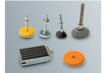
Les supports machines de nivelage permettent de monter les machines sur un sol inégal. Leur système de nivelage intégré permet une installation sûre et précise sur sol régulier ou irrégulier, et empêche efficacement le glissement de la machine. Particulièrement adaptés aux machines sans fixation au sol.
